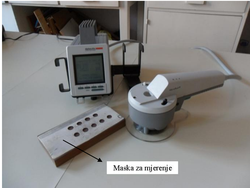
Slika 23. Spektralni fotometar Microflash 100d Datacolor
