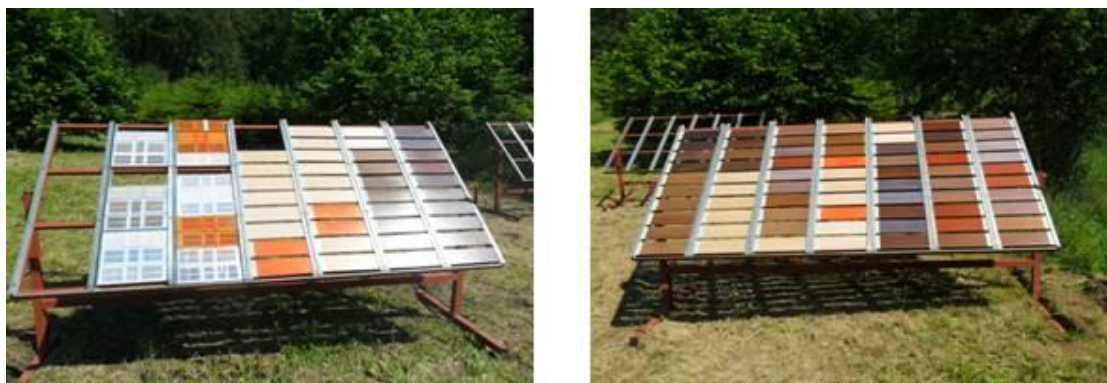
Slika 20. Prirodno izlaganje uzoraka na Nastavno-pokusnom šumskom objektu Dotrščina
