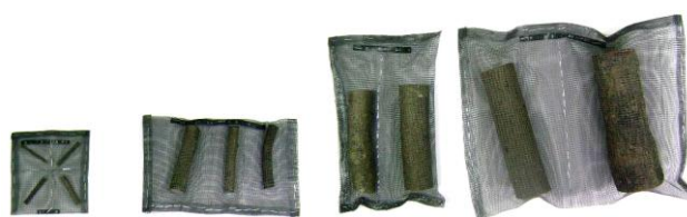
Slika 2.11. Vrećice za procjenu brzine razgradnje mrtvog drva za 4 dimenzije uzoraka.
