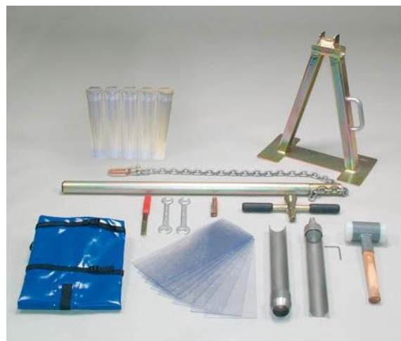
Slika 2.7. Sonda za uzorkovanje tla.
