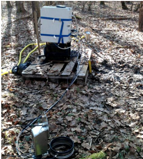
Slika 2.9. Sustav za izmjernu tok CO 2 iz tla postavljen u III dobnom razredu.
