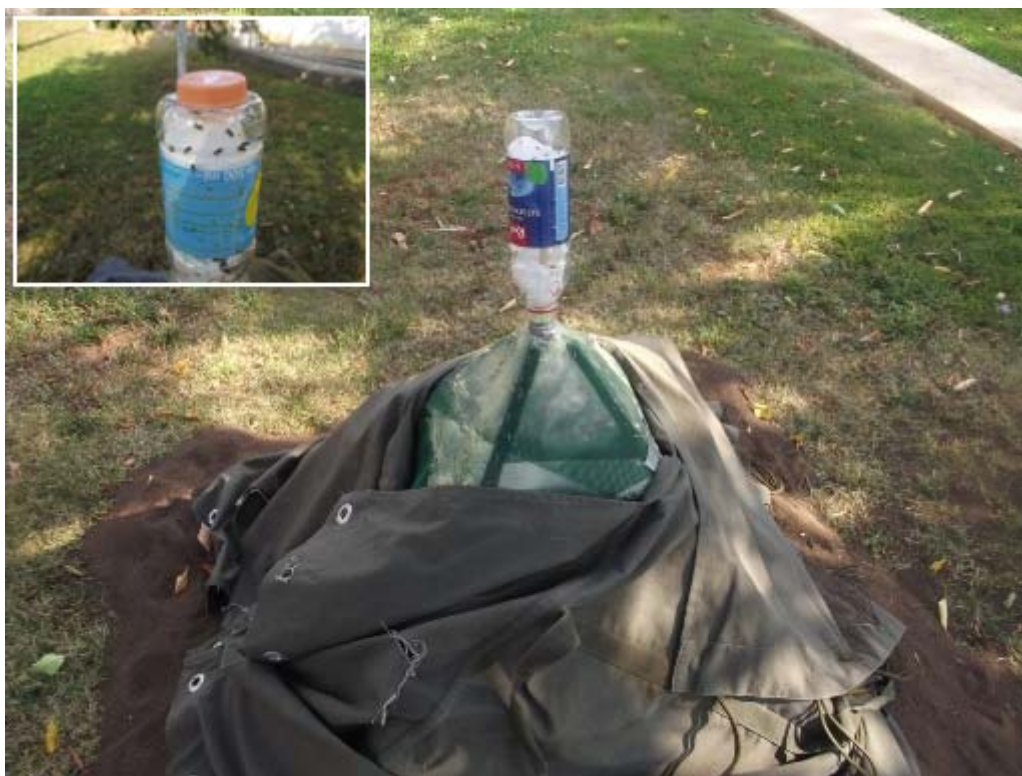
Slika 37. Fotoeklektor s lovnom posudom na vrhu. Detalj prikazuje jedinke smrekovog pisara u lovnoj boci nakon izlaska iz fotoeklektora
