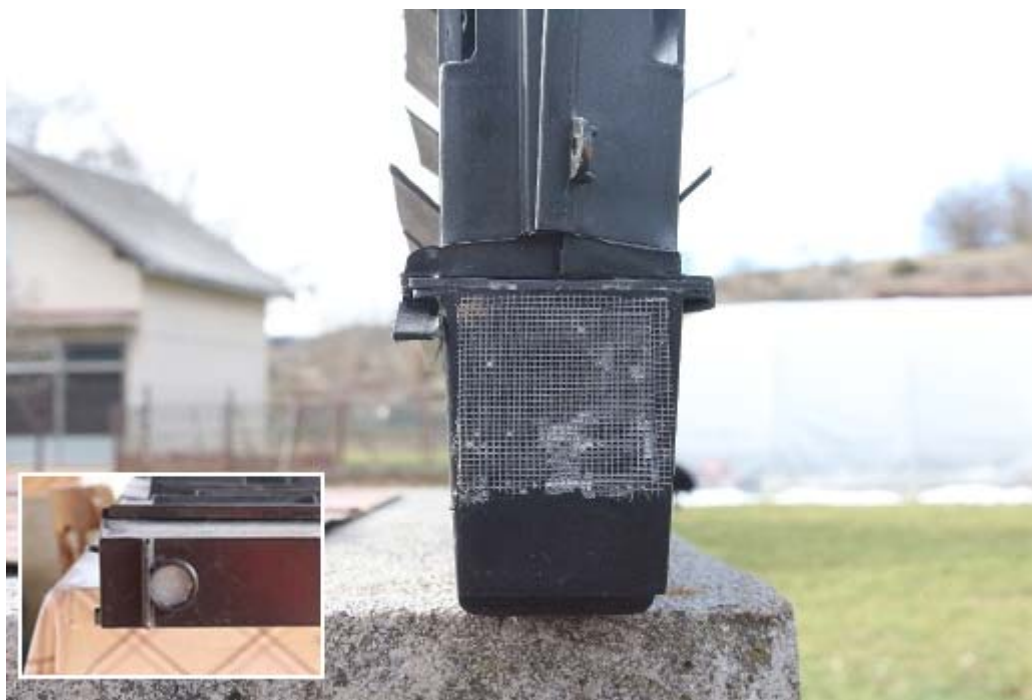
Slika 40. Modificirana mokra naletno barijerna crna Theysohn ® feromonska klopka s mrežicom na lovnoj posudi. Detalj prikazuje dno lovne posude koje je začepljeno silikonom
