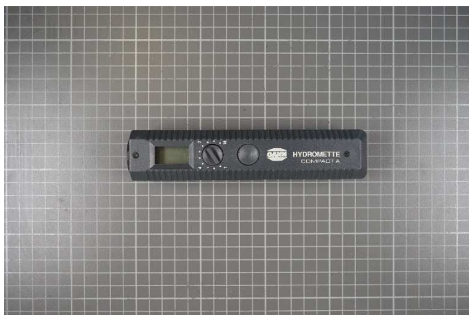
Slika 5. Uređaj za mjerenje sadržaja vode kapacitivnom metodom Gann Hydromette Compacta.
