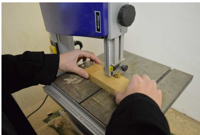
Slika 2. Piljenje popruga na tri identična uzorka.
