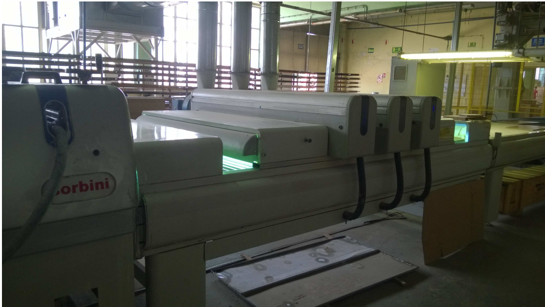
Slika 29. Dvostruki red UV lampi
