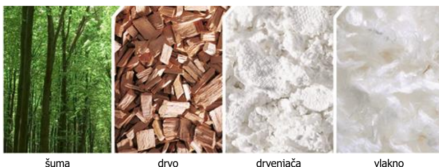
Slika 20. Tencel vlakno – prikaz dobivanja tencel vlakna
