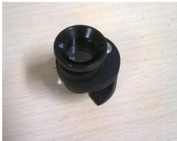
Slika 9. Lupa za mjerenje dubine penetracije
