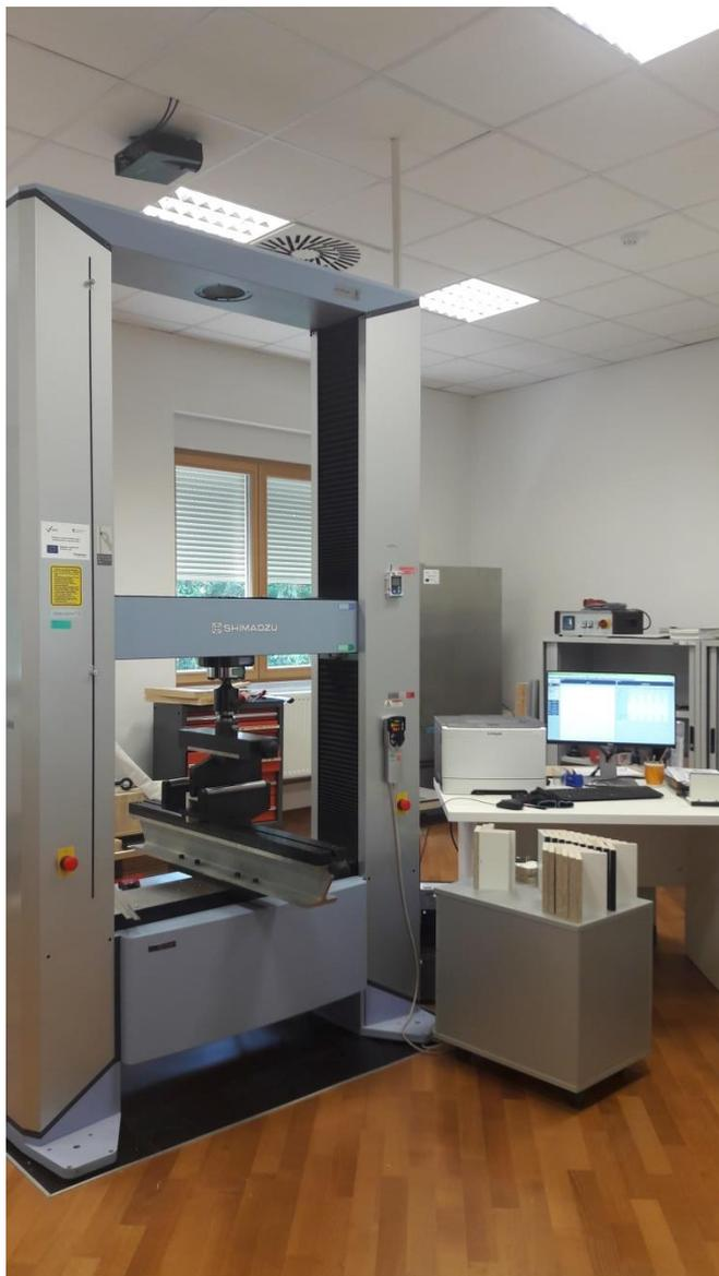
Slika 12. Kidalica shimadzu AG-X plus
