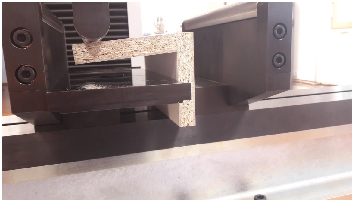
Slika 15. Uzorak za vrijeme ispitivanja u kidalici
