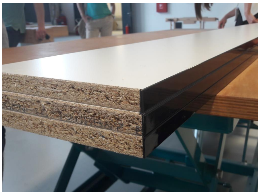
Slika 5. Troslojna iverica obložena ABS trakom
