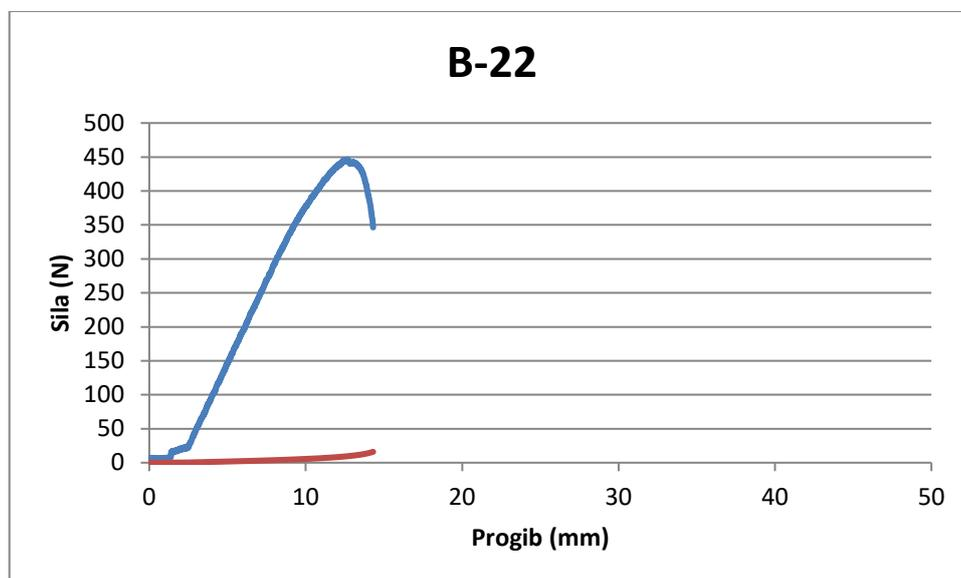
Slika 17. Prikaz dijagrama naprezanja za uzorak B-22
