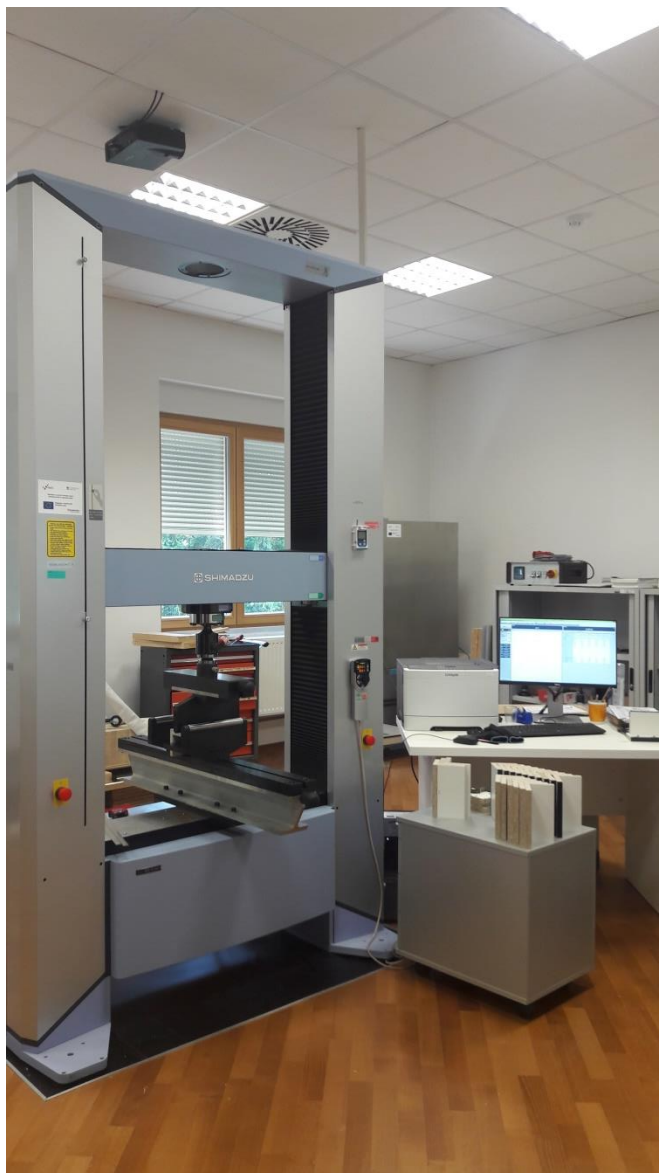
Slika 12. Kidalica shimadzu AG-X plus
