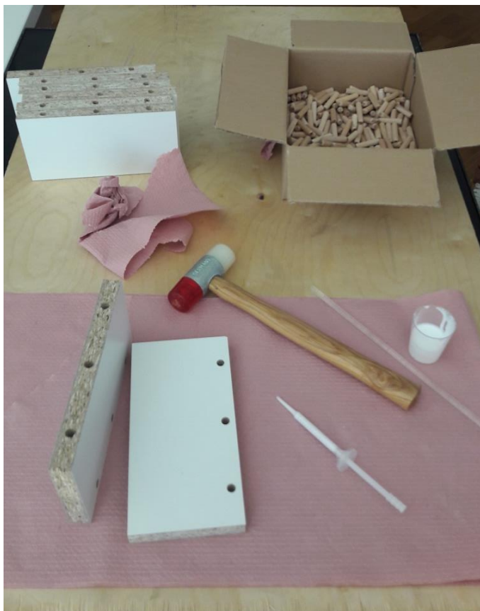
Slika 8. Pribor potreban za izradu uzoraka
