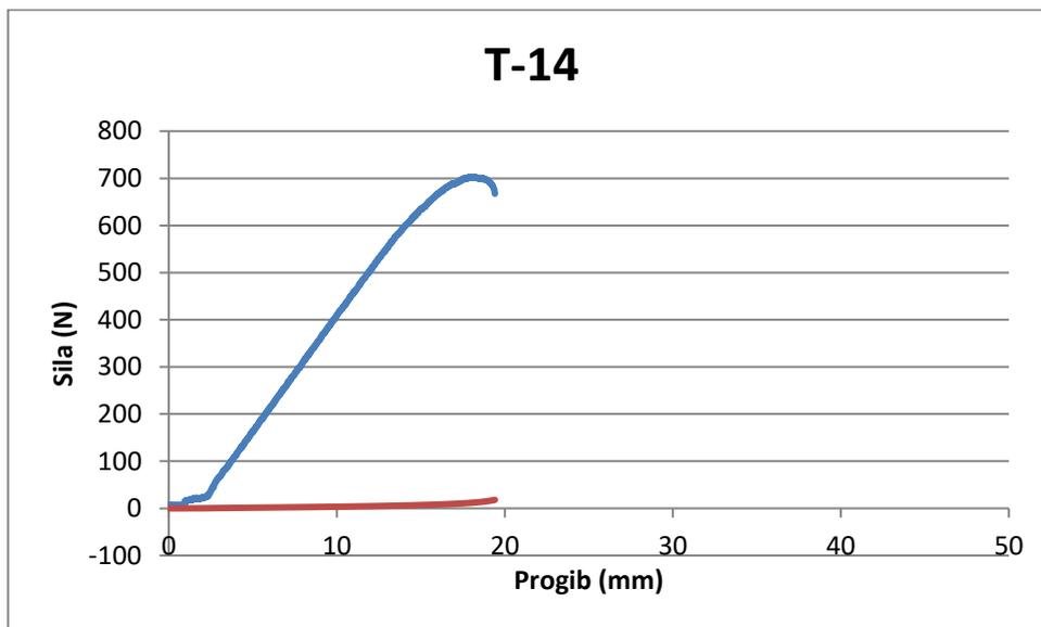
Slika 19. Prikaz dijagrama naprezanja za uzorak T-14
