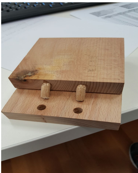
Slika 13. Potpuni lom i izvlačenje moždanika s minimalnom količinom nanosa ljepila
