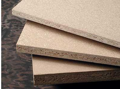
Slika 14 Troslojna ploča iverice
