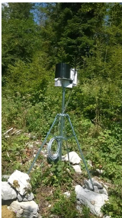
Slika 7. Meteorološka stanica Spectrum u malom šumskom otvoru
