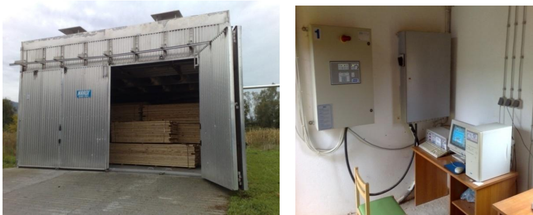
Slika 11. Sušionica i upravljačka jedinica http://drvene-konstrukcije.hr/karakteristike-lld/
