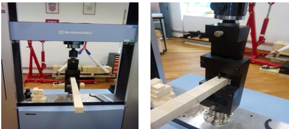
Slika 22. Ispitivanje čvrstoće na smik
