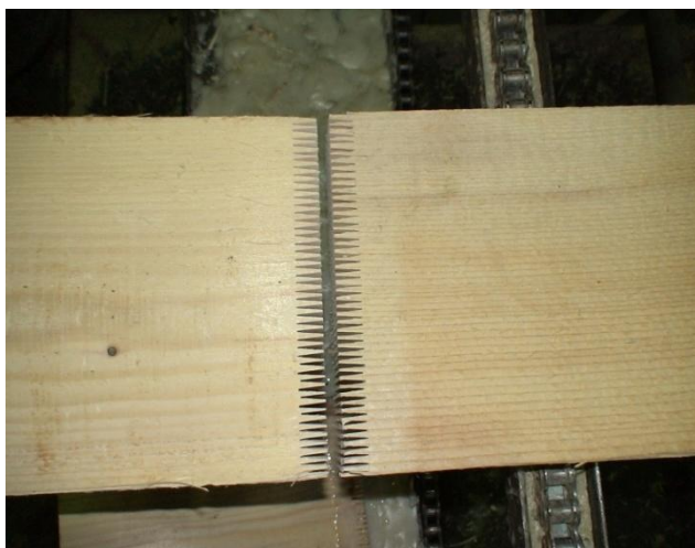
Slika 12. Izgled zubaca http://drvene-konstrukcije.hr/karakteristike-ild/
