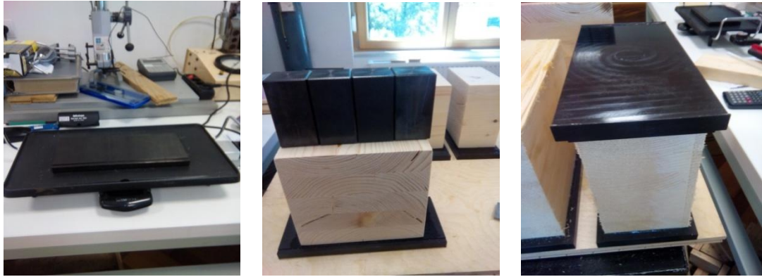
Slika 20. Faze pripreme uzoraka za ispitivanje čvrstoće na vlak
