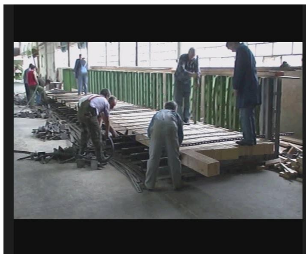
Slika 15. Postolje za pritezanje lamela http://drvene-konstrukcije.hr/karakteristike-ld/
