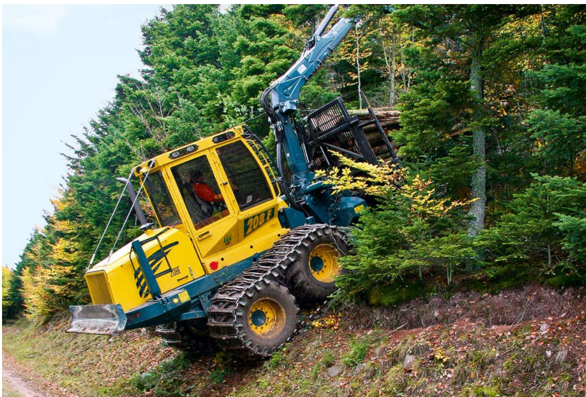
Slika 2. Forvarder HSM 208 F pri svladavanju terenskih prepreka
