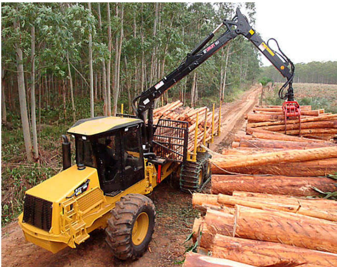
Slika 5. Forvarder Caterpillar prilikom istovara na pomoćnom stovarištu
