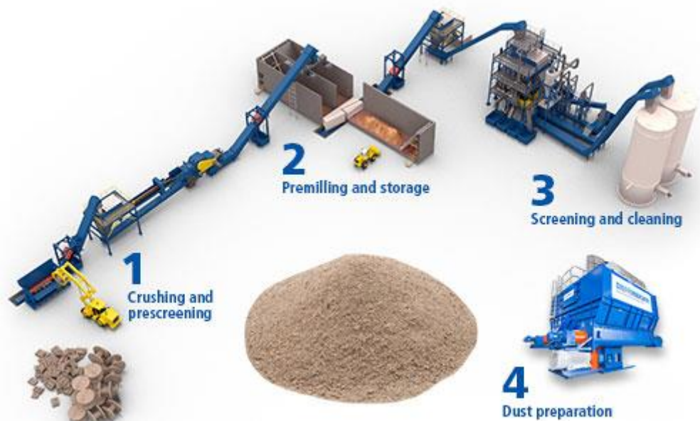
Slika 1. Pojednostavljeni prikaz recikliranja drva u sitnu sječku
