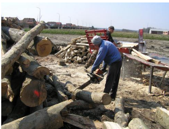
Slika 13. Prikraćivanje i izrada metrice oblice motornom lančanom pilom
