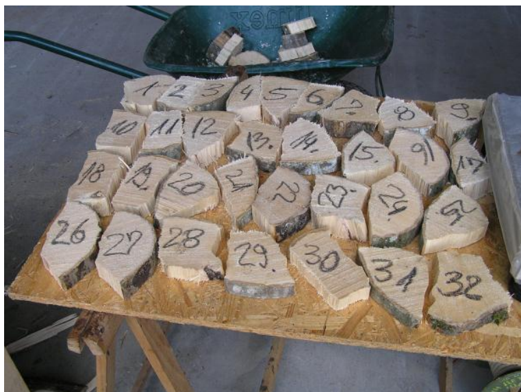
Slika 21. Uzorci iz cjepanica za mjerenje vlage gravimetrijskom metodom
