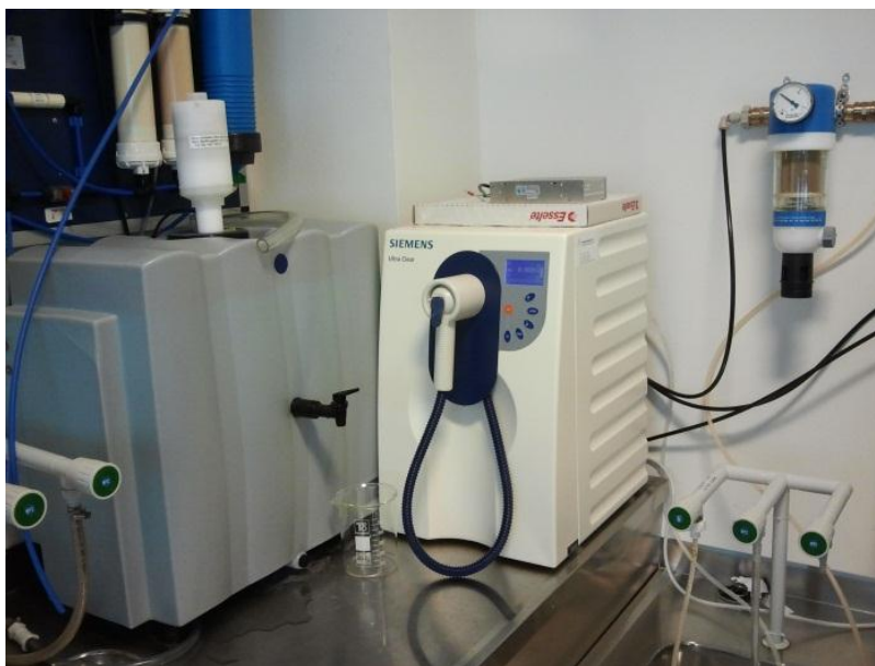
Slika 5. Uređaj za pripravu ultračiste vode Siemens Ultra clear
