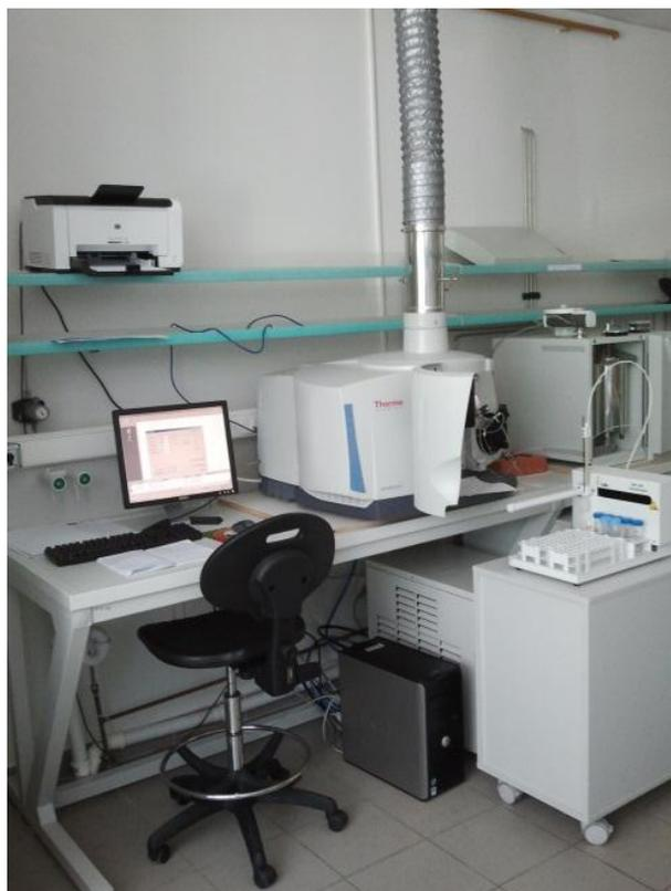
**Slika 7.** Spektrometar ICP-AES Thermo Fischer iCAP6300 Duo
