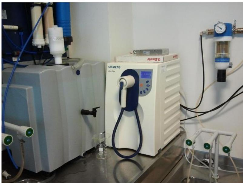
**Slika 5.** Uređaj za pripravu ultračiste vode Siemens Ultra clear
