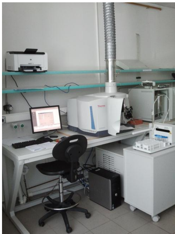
Slika 7. Spektrometar ICP-AES Thermo Fischer iCAP6300 Duo
