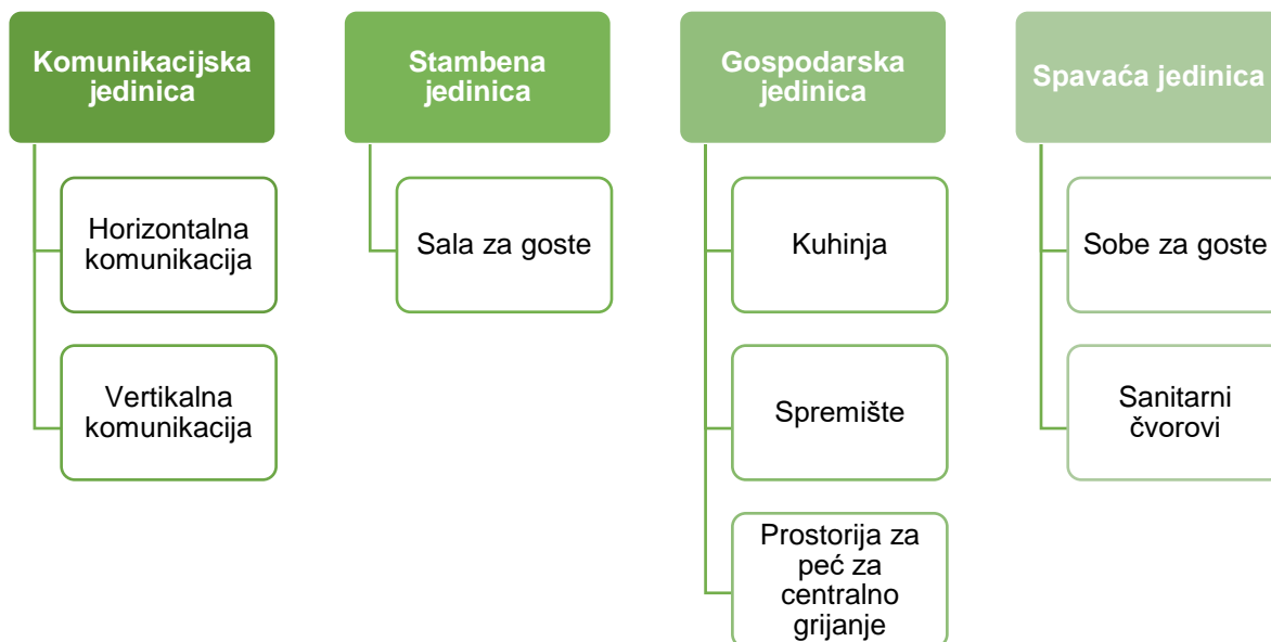
Slika 29. Osnovne funkcijske jedinice prostora u glavnoj zgradi
