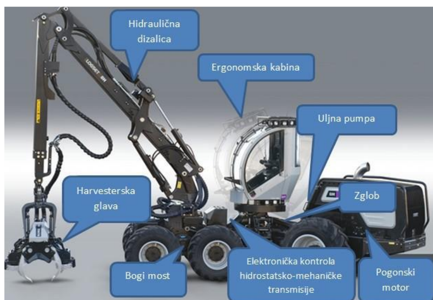
Slika 10. Sastavni dijelovi harvestera (Izvor: Granić 2013)
