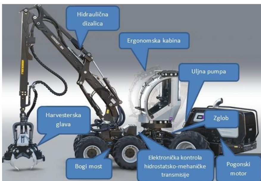
Slika 10. Sastavni dijelovi harvestera (Izvor: Granić 2013)
