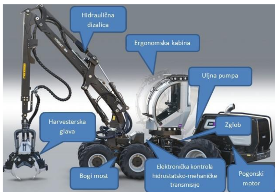
Slika 10. Sastavni dijelovi harvestera (Izvor: Granić 2013)
