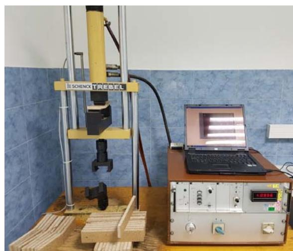
*Slika 9. Univerzalni uređaj za ispitivanje mehaničkih svojstava*
