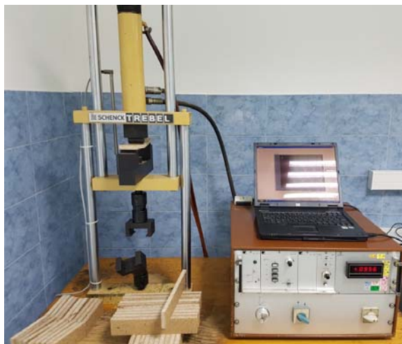
Slika 9. Univerzalni uređaj za ispitivanje mehaničkih svojstava
