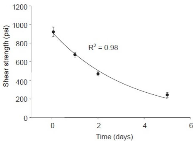
**Slika 2.** Pad vrijednosti smične čvrstoće ploča u ovisnosti o vremenu pripreme taninskog ljepila
