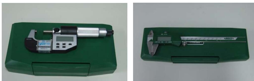
*Slika 8. Digitalni mikrometar i pomično mjerilo*
