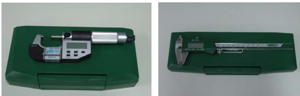
Slika 8. Digitalni mikrometar i pomično mjerilo
