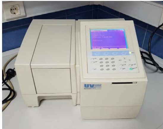
Slika 10. Spektrofotometar Shimadzu UV-mini 1240
