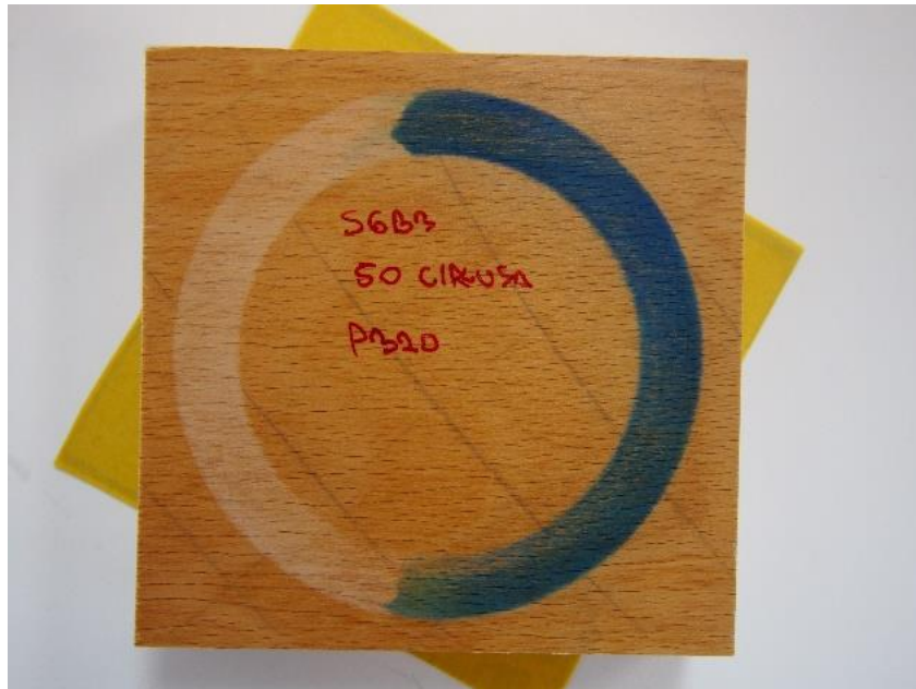
Slika 3: Potrošeni uzorak nakon 50 ciklusa
