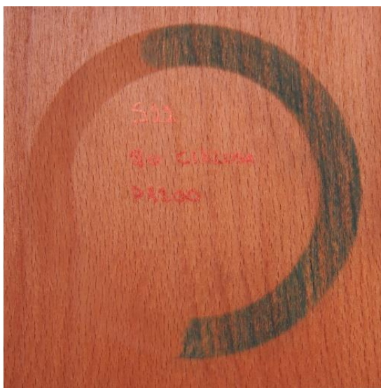
Slika 26: Uzorak S2-4 nakon 90 ciklusa
