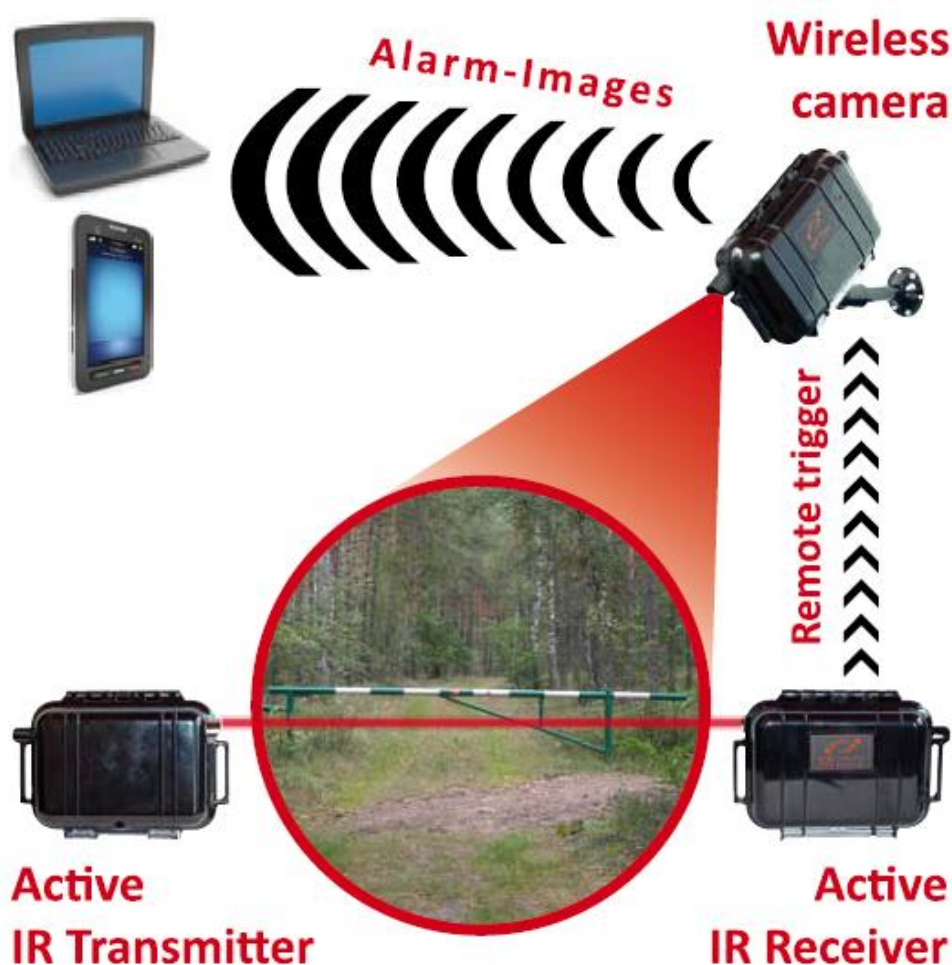
Slika 4. Počelo rada aktivne infracrvene kamere. Izvor: http://www.elfiportablesecurity.com
