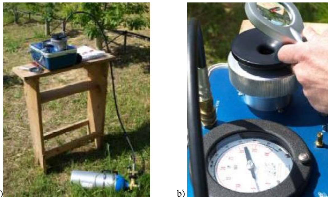
Slika 10. Instrument za mjerjenje vodnog potencijala Pressure Chamber Instrument Model 600 (PMS Instrument Company), a) instrument spojen na bocu pod tlakom, b ) analogni mjerač i komora na instrumentu
