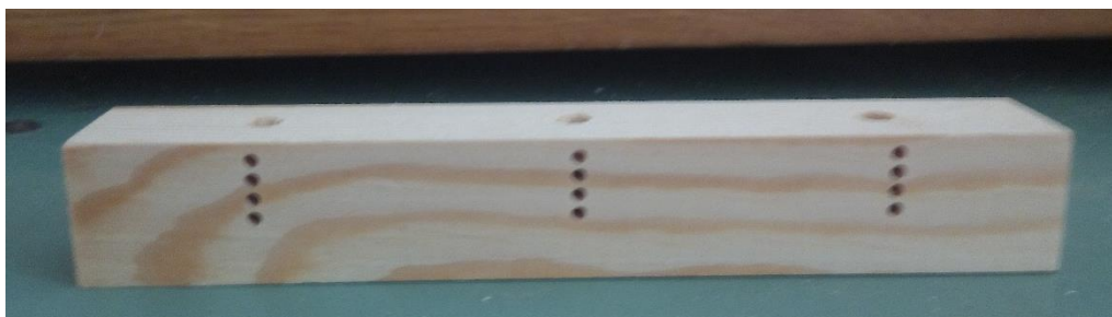
Slika 6. Ispitni uzorak borovine
