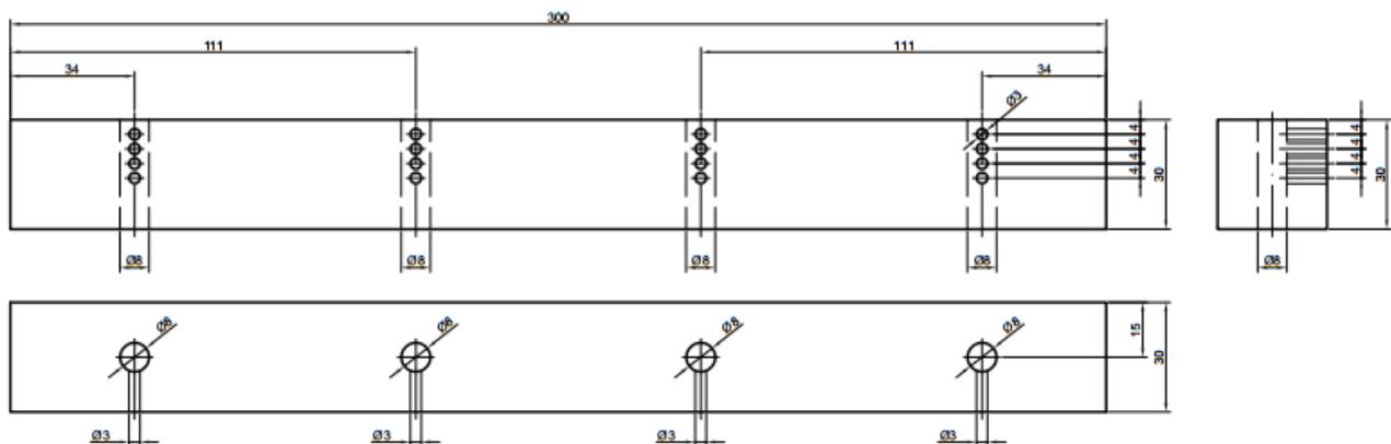
Slika 7. Shematski prikaz ispitnog uzorka bukovine
