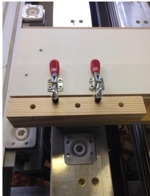
Slika 10. Bušenje provrta za moždanike na uzorku borovine
