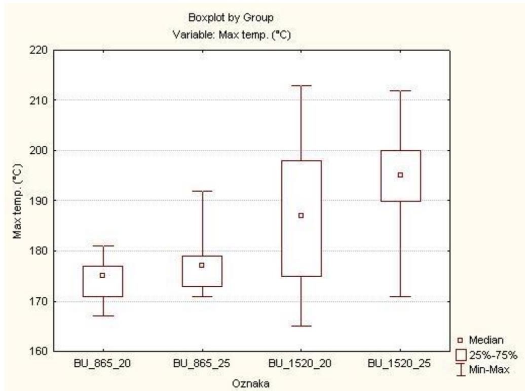
Slika 31. Usporedba temperature zavarivanja bukovine
