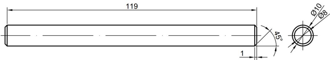
Slika 12. Dimenzija moždanika potrebnog za ispitivanje
