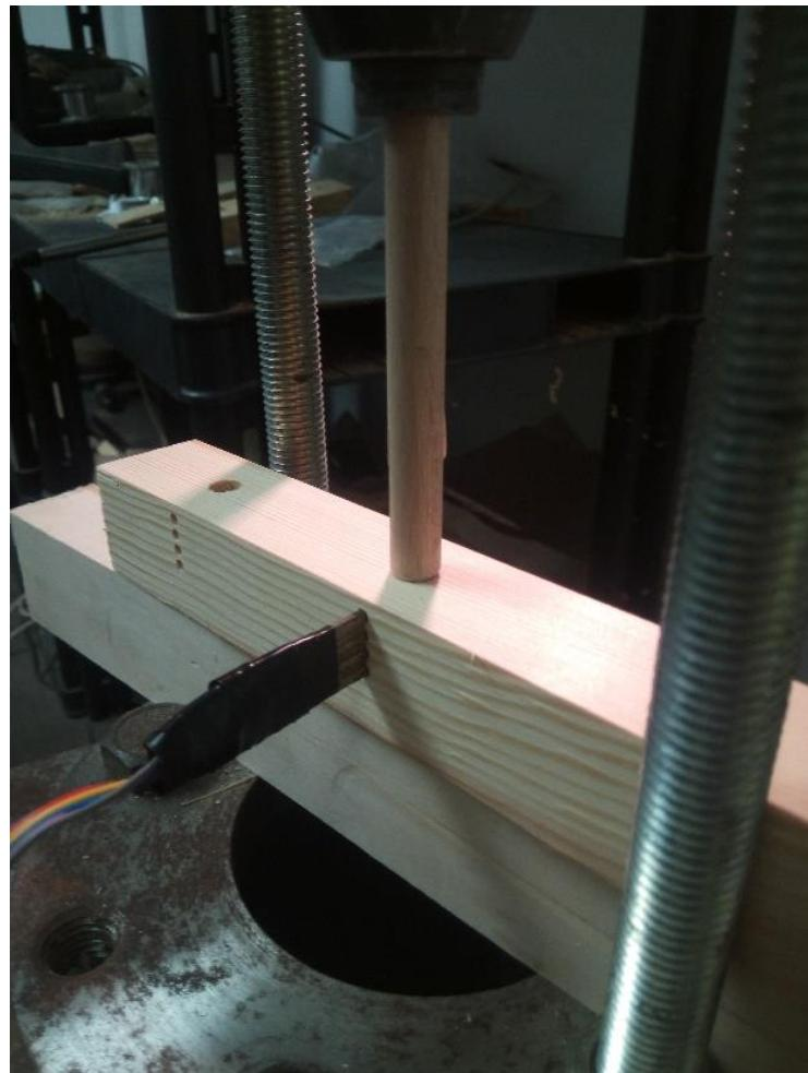
Slika 14. Zavarivanje uzorka
