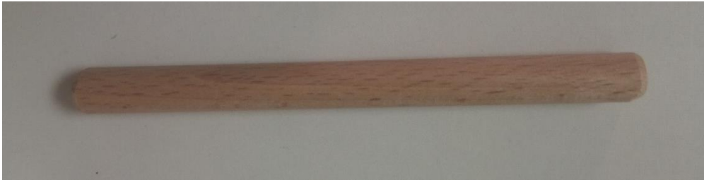
Slika 13. Bukovi moždanik korišten kod rotacijskog zavarivanja drva
