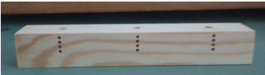
Slika 6. Ispitni uzorak borovine
