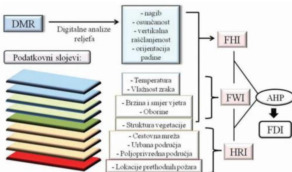
Slika 8. Primjer konceptualnog modela za određivanje indeksa opasnosti od požara
