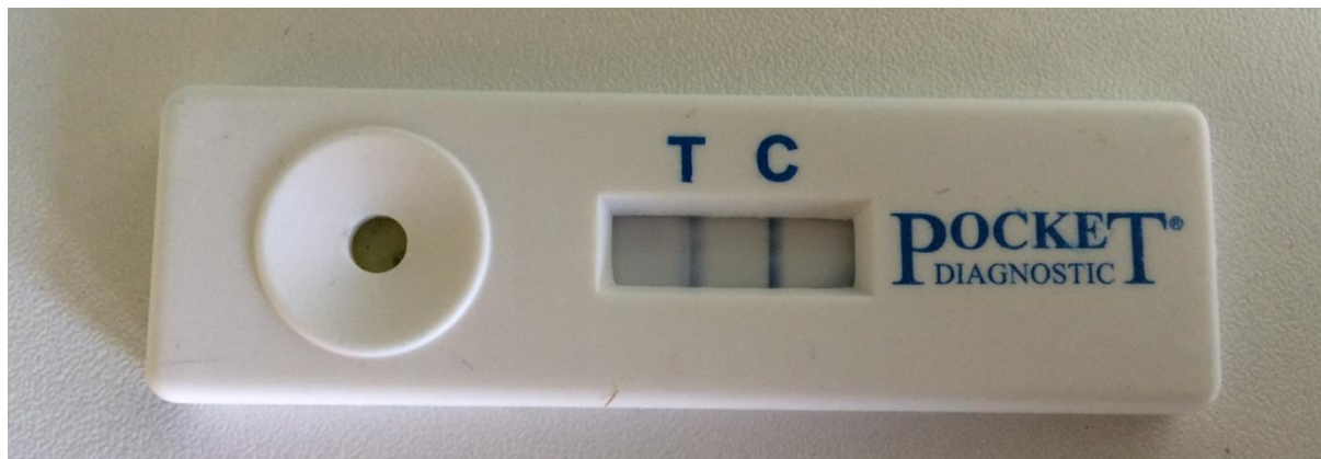
Slika 3. Terenski dijagnostički test koji pokazuje pozitivan rezultat na prisustvo vrsta roda Phytophthora u ispitivanom tkivu
