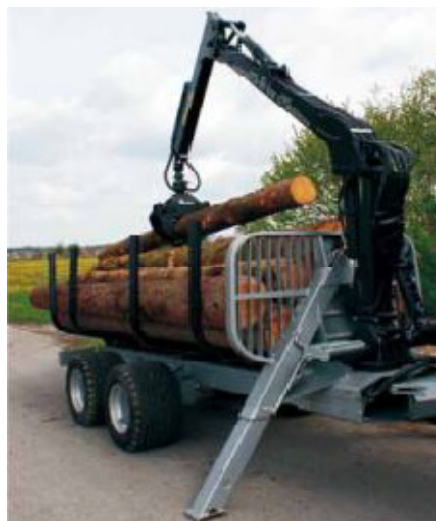
Slika 10. Prikolica RW 9242 K-Line u izvedbi za prijevoz trupaca
