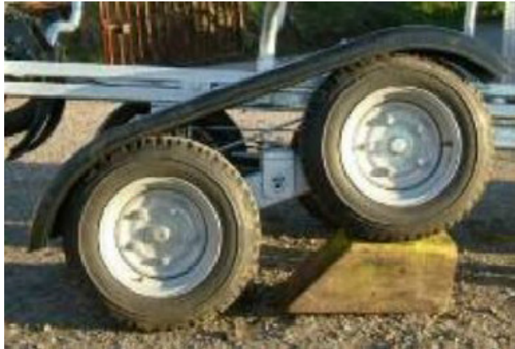
Slika 9. Ovjes s hodajućim gredama na prikolici Riko Fast Tow Forwarding trailer
