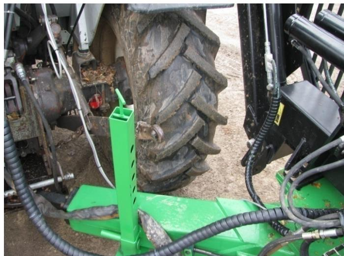
Slika 11. Zakretanje ruda pomoću horizontalnog zgloba
