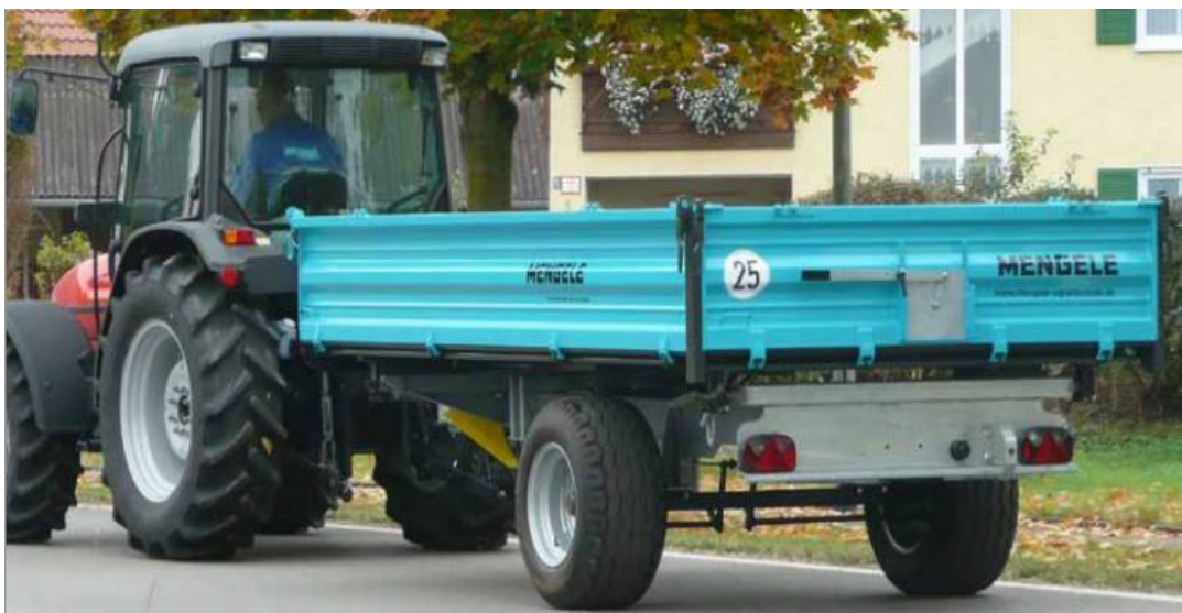
Slika 3. Jednoosovinska prikolica tvrtke Mengele grupa modela MEDK 3000-8000
