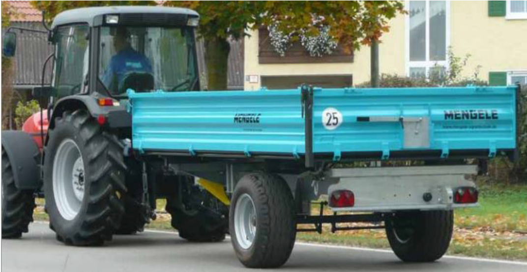
Slika 3. Jednoosovinska prikolica tvrtke Mengele grupa modela MEDK 3000-8000
