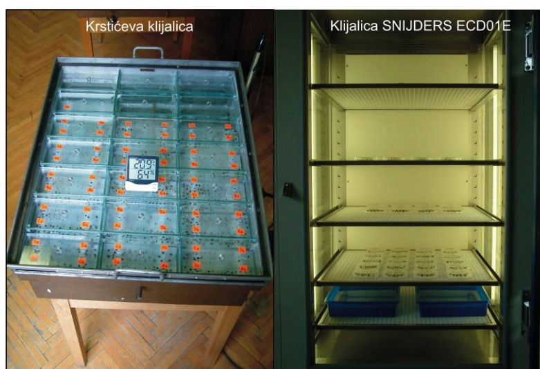
Slika 22. Krstičeva klijalica otvorenog tipa i klijalica SNIJDERS ECD01E zatvorenog tipa
