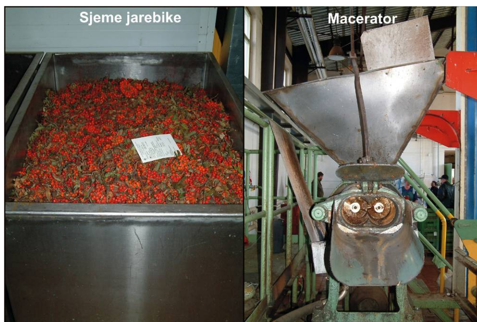
Slika 7. Sjeme jarebike i macerator za odvajanje sjemena od mesnatog usplođa (Foto: D. Drvodelić, Semenářský závod Týniště nad Orlicí, Republika Češka, 2003)
