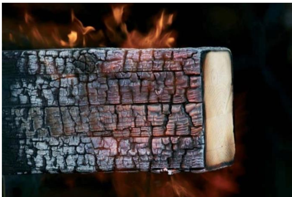
Slika 6. Primjer poprečnog presjeka iz kojeg se mogu izračunati nosiva svojstva drva.
