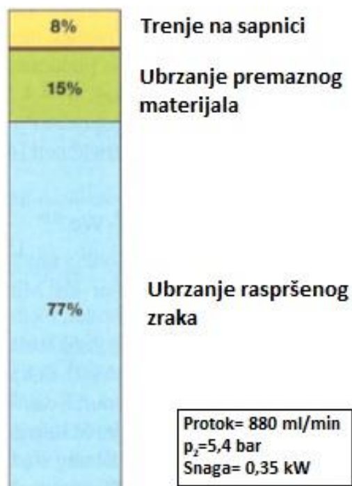
Slika 11. potrošnja zraka, potrošnja i energetska bilanca tijekom zračnog štrcanja (Goldschmidt., Streitberger, 2002)
