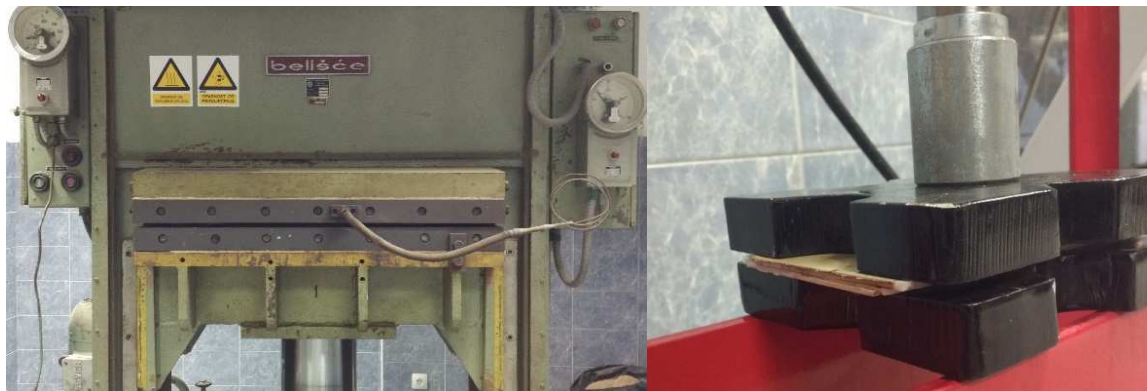
Slika 8. Postupci vrućeg i hladnog prešanja
