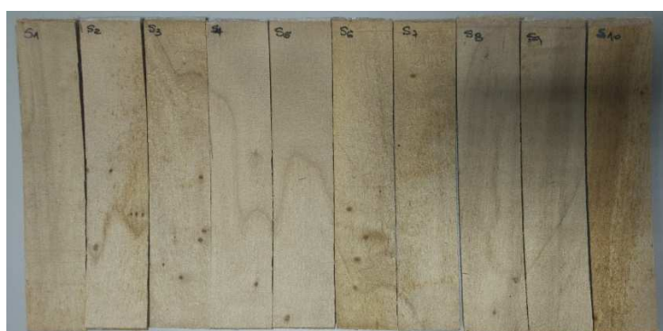
Slika 10. Uzorci WPC za ispitivanje savojne čvrstoće i modula elastičnosti
