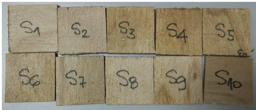
Slika 9. Uzorci WPC pripremljeni za ispitivanje fizikalnih svojstava
