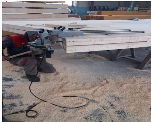
Slika 30. Izrada upusta i ureza
