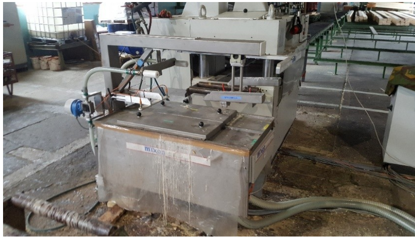
Slika 22. Proces lijepljenja lamela
