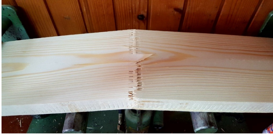
Slika 19. Ispitivanje zupčastog spoja
