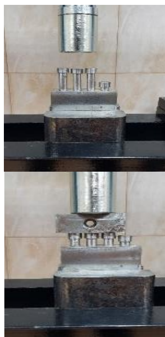
Slika 36. Prešanje uzoraka u tablete
