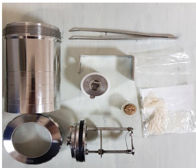
Slika 39. Dijelovi kalorimetrijske bombe i oprema za rukovanje
