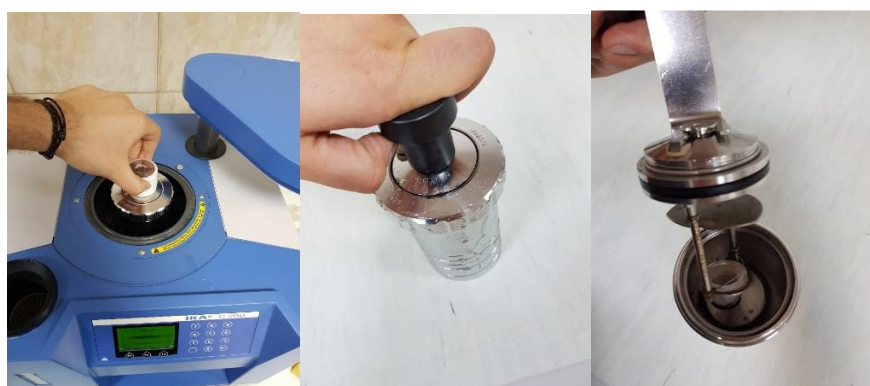
Slika 43. Ispuštanje kisika i pražnjenje kalorimetrijske bombe
