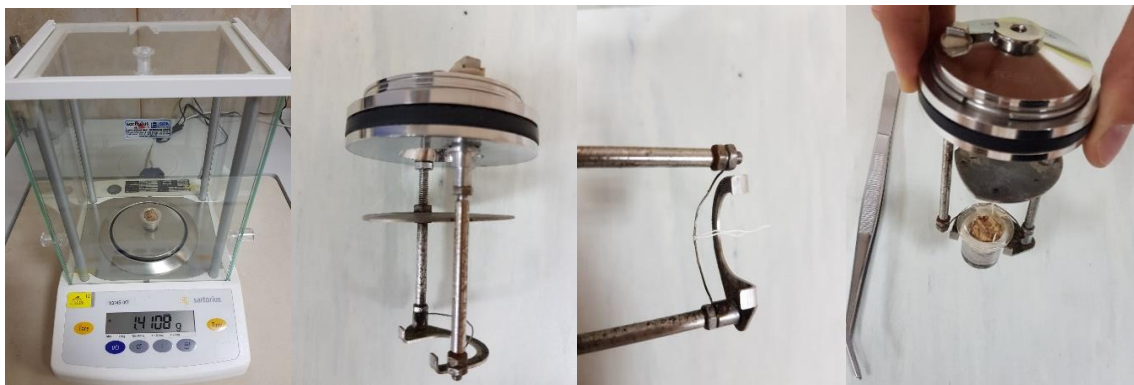
Slika 40. Početak pripreme kalorimetarske bombe (priprema i postavljanje tablete)
