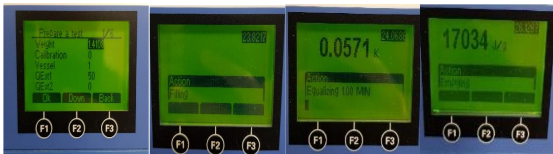
Slika 42. Tijek procesa, automatskog mjerenja gornje ogrjevne vrijednosti kalorimetra IKA C200
