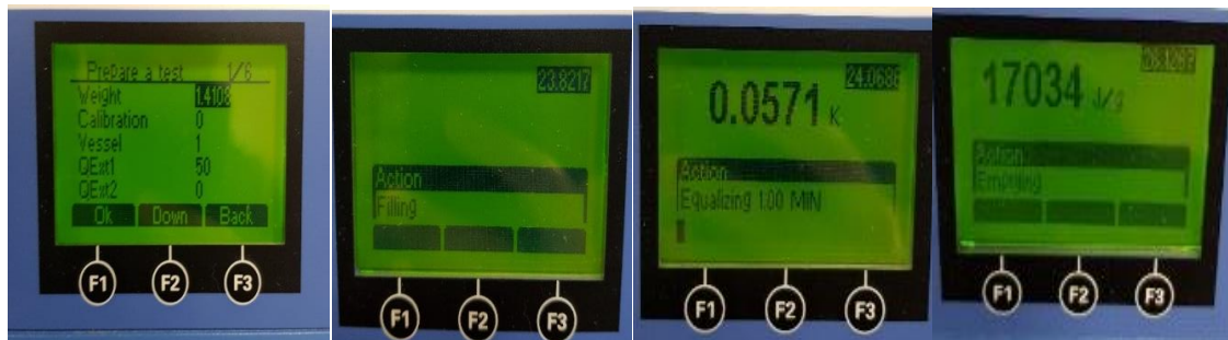
Slika 42. Tijek procesa, automatskog mjerenja gornje ogrjevne vrijednosti kalorimetra IKA C200
