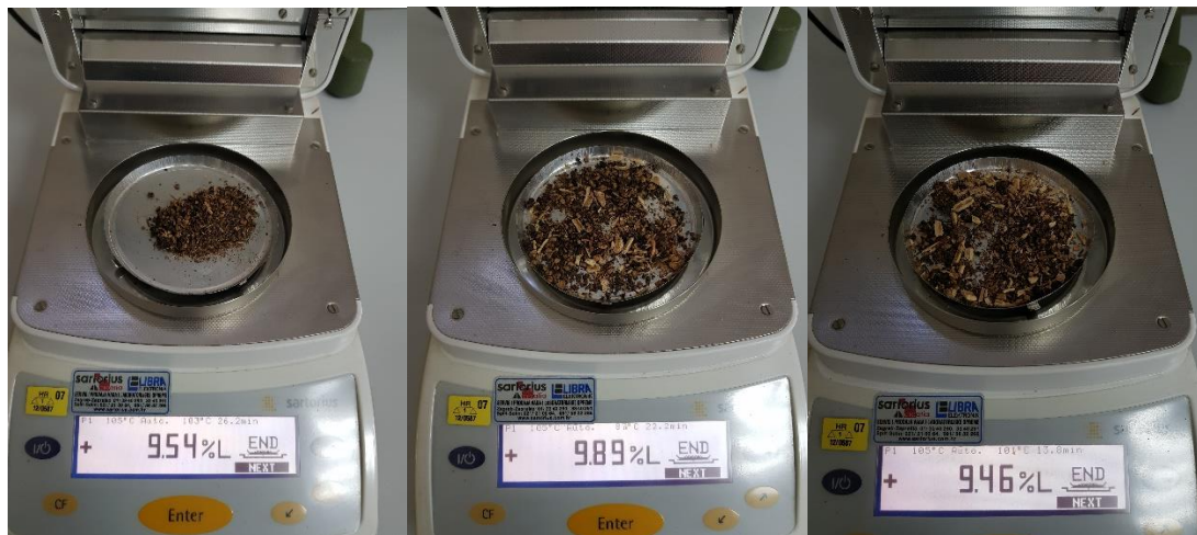
Slika 29. Određivanje sadržaja vode mješavine B, pomoću IC analizatora Sartorius MA150
