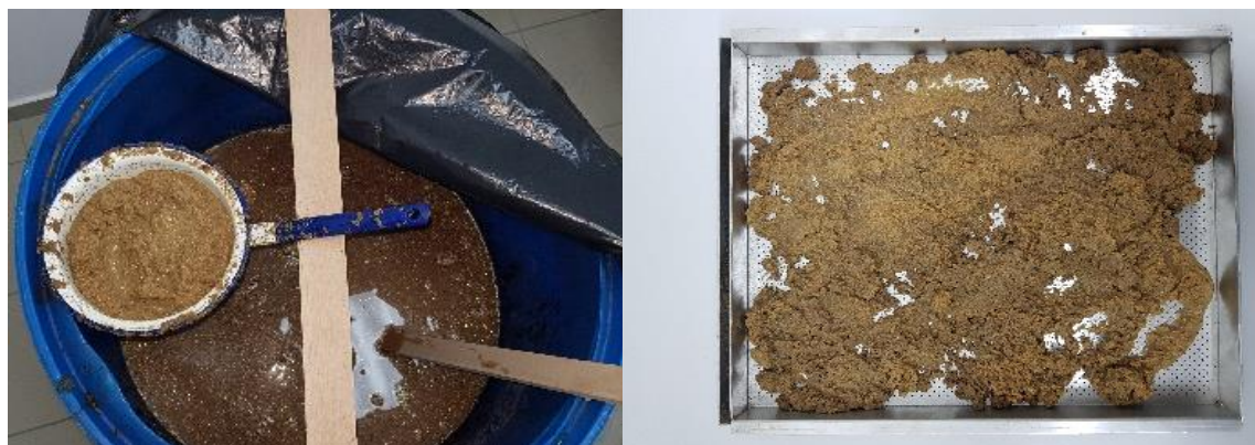
Slika 15. Uzorak vlažne maslinove komine u bačvi (lijevo) i u posudi sa sitom (desno)
