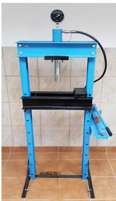
Slika 37. Hidraulična preša (20 t)
