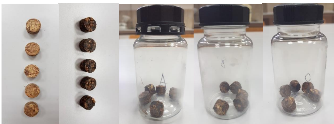
Slika 38: Tablete isprešane iz uzoraka (s lijeva na desno): vinove loze, maslinove komine te mješavina A, B i C
