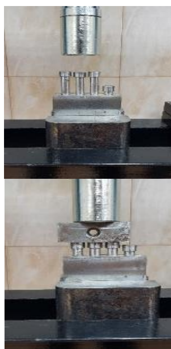
Slika 36. Prešanje uzoraka u tablete
