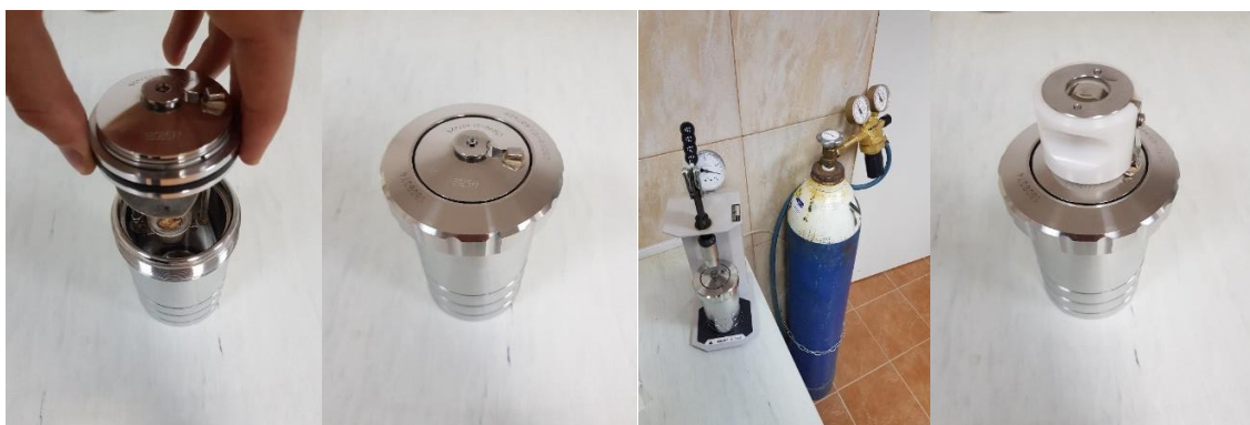
Slika 41. Zatvaranje kalorimetrijske bombe i punjenje kisikom
