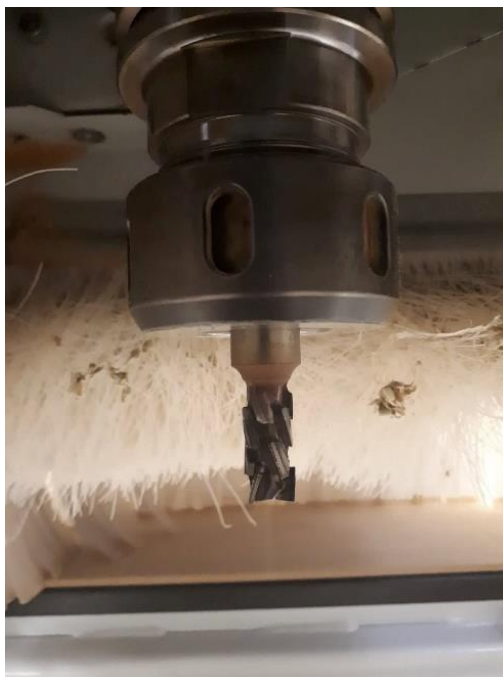
Slika 12. Izgled prihvata alata (glodala) sa čahurom
