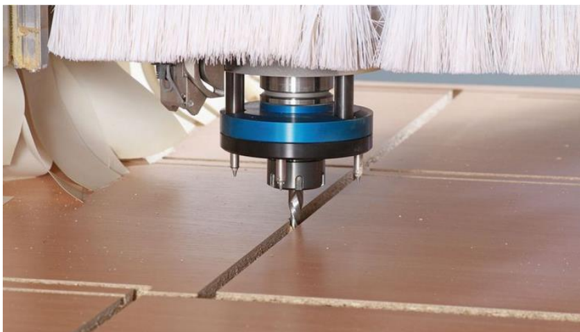
Slika 2. Alat (glodalo) u zahvatu kod krojenja ploča nesting tehnologijom
