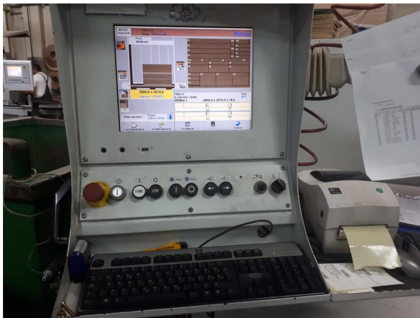
Slika 14. . Izgled sučelja programa tokom raskrajanja na stroju PANHANS EURO 5.1
