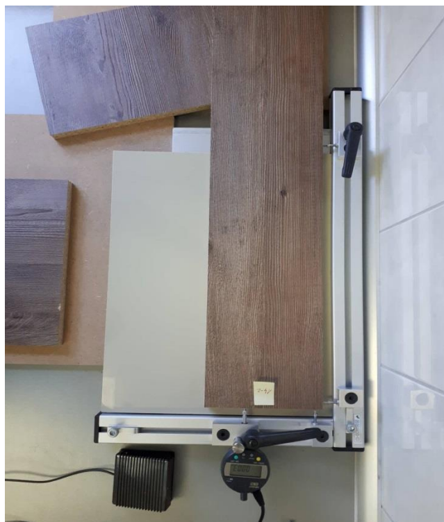
Slika 15. Mjerni alat za mjerenje pravokutnosti
