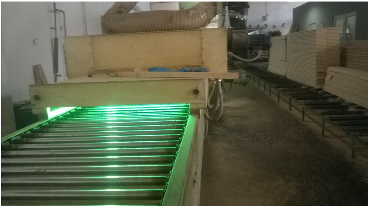
Slika 20. Stroj s UV svjetiljkama za otvdnjavanje akrilnih lakova.
