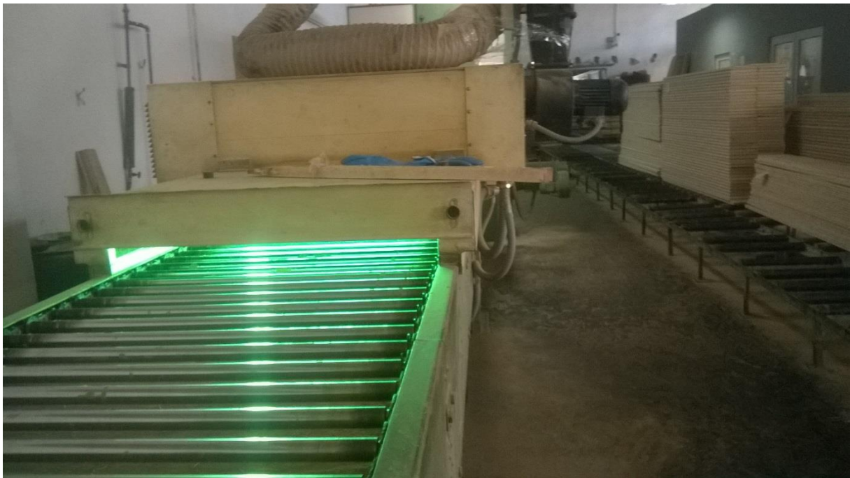
Slika 20. Stroj s UV svjetiljkama za otvdnjavanje akrilnih lakova.
