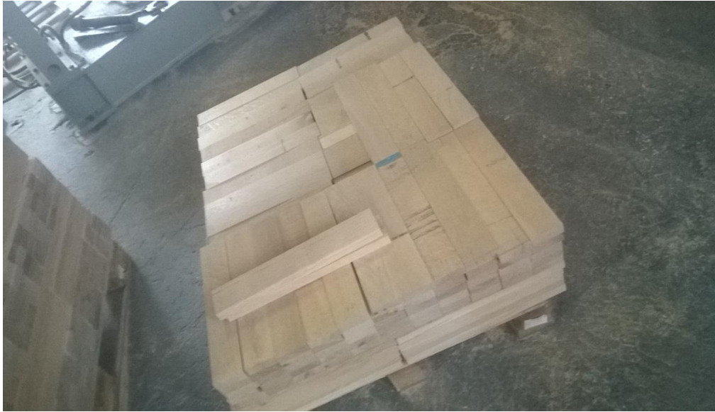
Slika 4. Elementi koji su izašli iz četverostrane blanjalice
