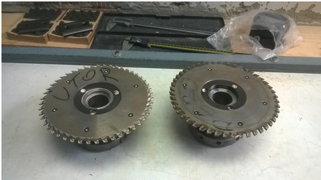
Slika 25. Pile za izradu utora i pera.
