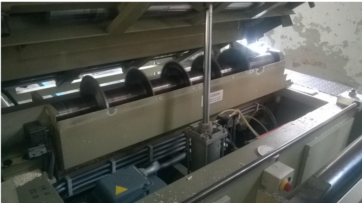
Slika 16. Pile na višelisnom cirkularu za raspiljivanje slijepljenih ploča u parketne daske.
