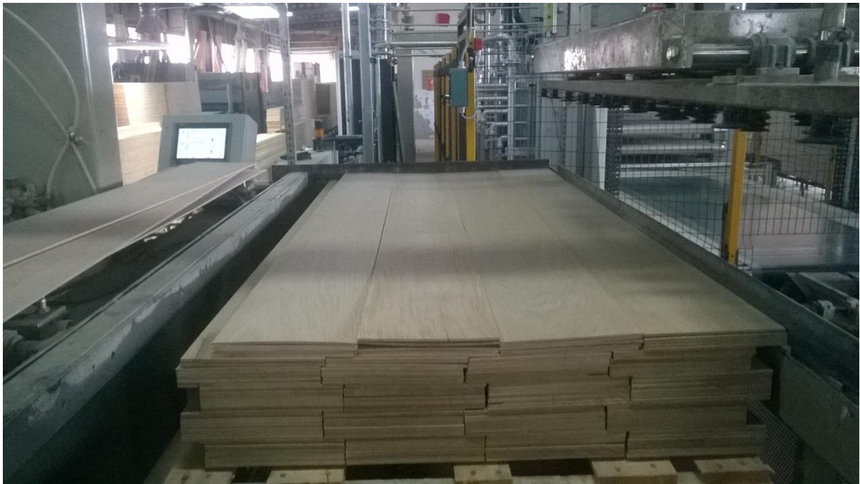
Slika 13. Priprema lica (1 strip) prije ulaska u prešu.
