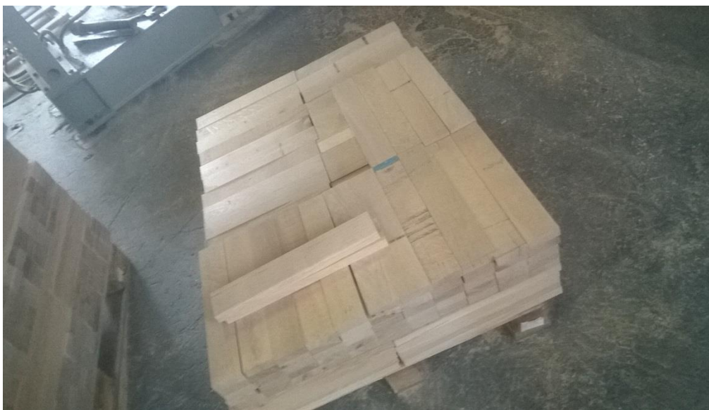
Slika 4. Elementi koji su izašli iz četverostrane blanjalice
