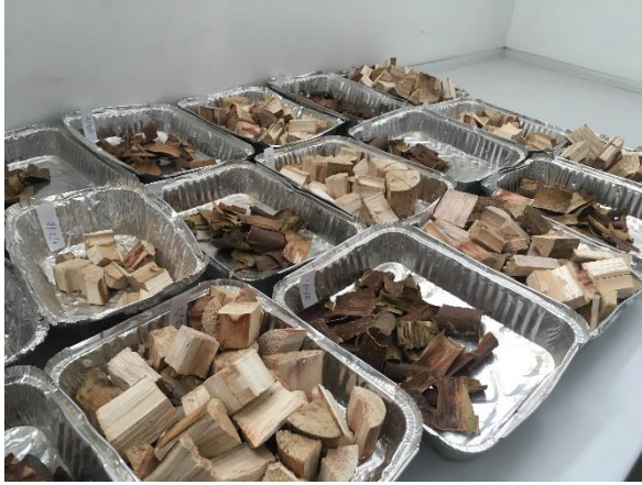
Slika 9. Primarno usitnjeni uzorci drva i kore
