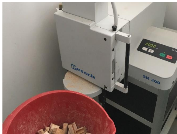
Slika 10. Rezni mlin Retsch SM 300
