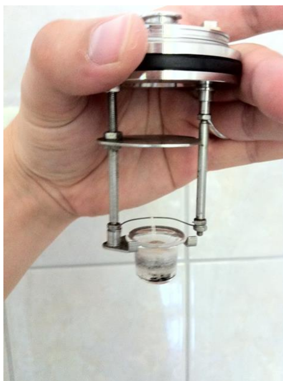
Slika 16. Detalj kalorimetarske bombe
