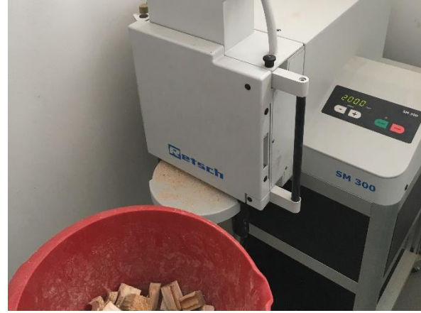
Slika 10. Rezni mlin Retsch SM 300
