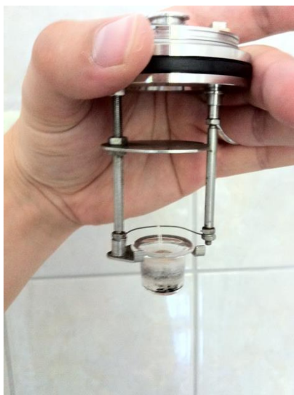
Slika 16. Detalj kalorimetarske bombe
