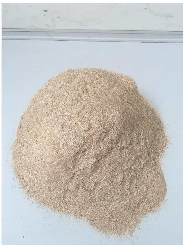
Slika 13. Analitički uzorak nakon usitnjavanja na nominalnu veličinu čestica < 1 mm
