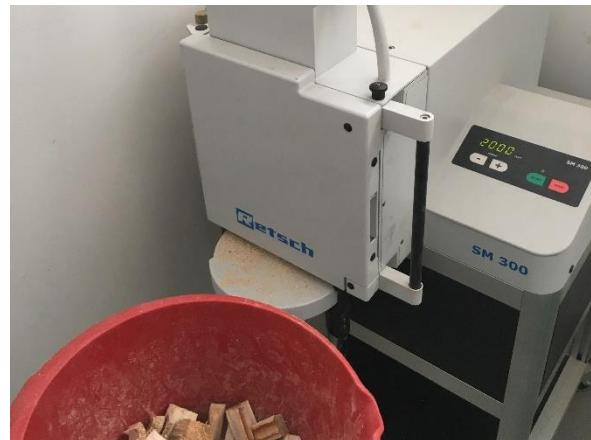
Slika 10. Rezni mlin Retsch SM 300
