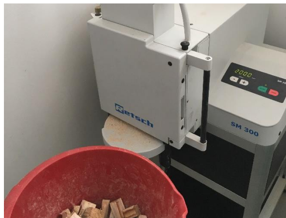
Slika 10. Rezni mlin Retsch SM 300
