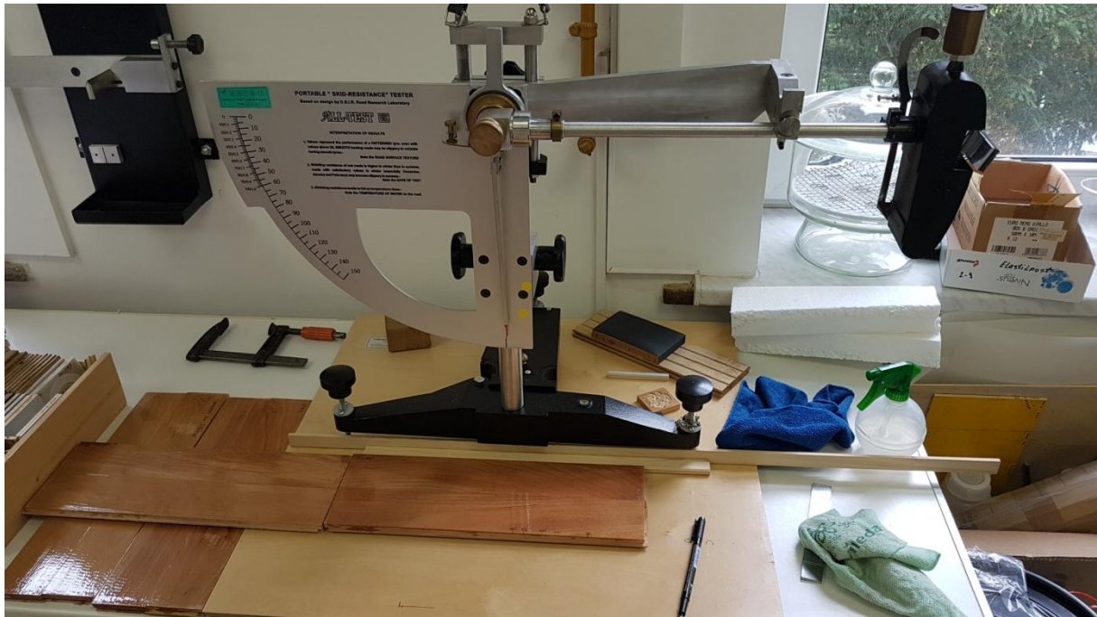
Slika 19. Njihalo za ispitivanje klizavosti
