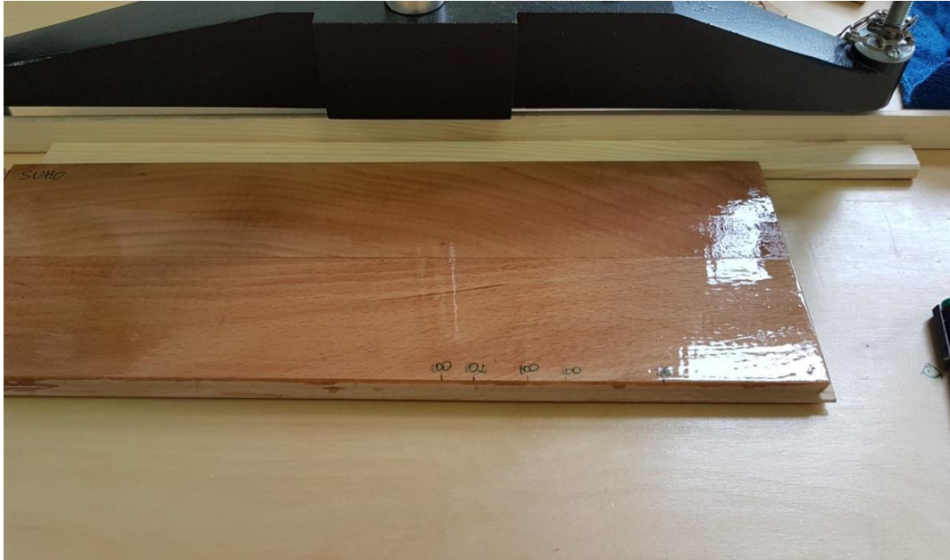
Slika 22 Ispitivanje klizavosti na "suho"
