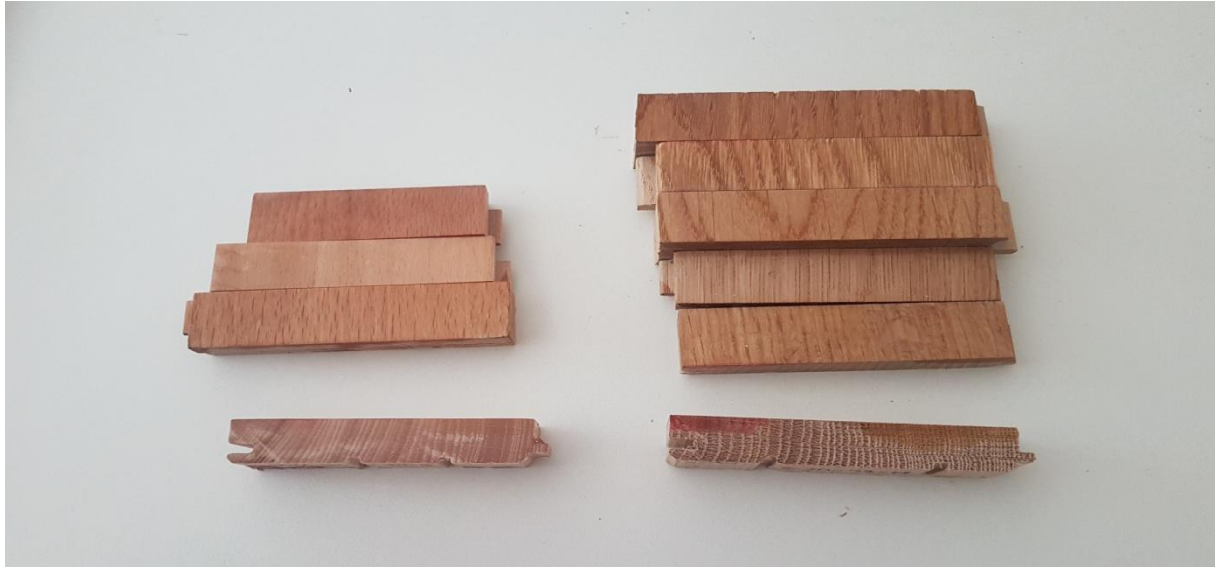
Slika 15. uzorci za mjerenje debljine filma
