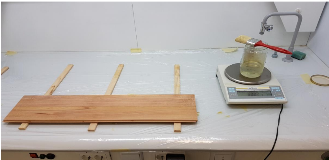
Slika 13. mjerenje količine nanosa uz pomoć digitalne vage
