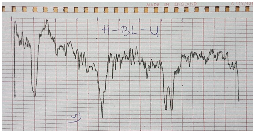
Slika 46 mjerenje hrapavosti na uzorku hrastovina-blistača-ulje
