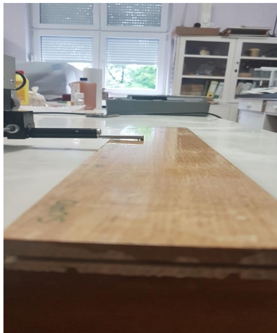
Slika 28 mehanički kontakt između igle i površine
