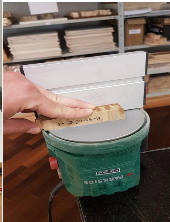
Slika 17. rotacijska brusilica (P1200)
