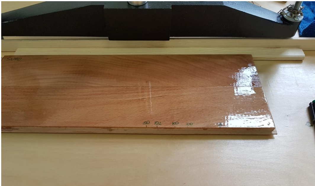
Slika 22 Ispitivanje klizavosti na "suho"
