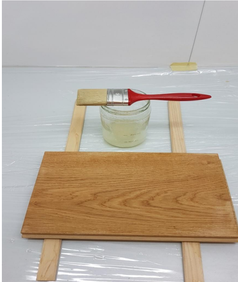
Slika 14. nanošenje ulja kistom
