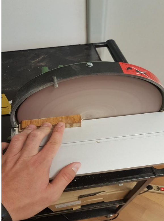
Slika 16. rotacijska brusilica (P240)
