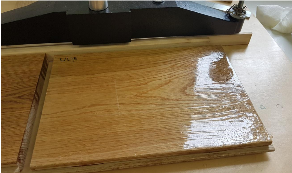
Slika 26 uzorak na kojem smo ispitivali klizavost pri utjecaju ulja na površinu uzorka
