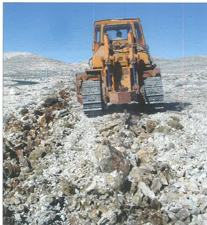
Slika 12. Riperač u pripremi tla za pošumljavanje Figure 12 Ripper preparing the soil for afforestation
