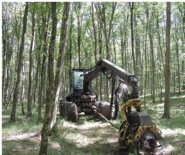
Slika 21. Harvester Timberjack 1470D
